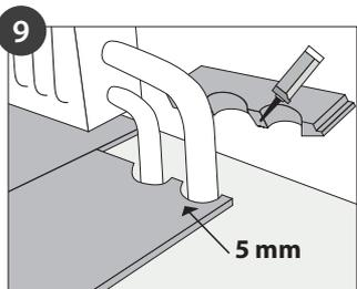
Falls sie einen Abschnitt an Bauteilen wie Heizkörpern, Pfeilern o.ä. anpassen, achten Sie bitte auch hier auf den Abstand von mind. 5,0mm und verleimen das angesetzte Stück abschließend an den Schnittstellen.
