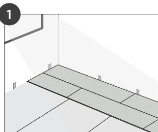
Die empfohlene Verlegerichtung ist längsseitig zur einfallenden Hauptlichtquelle. Als maximale zusammenhängende Verlegefläche empfehlen wir 10,00mtr. x 10,00mtr. Größere Flächen darüber hinaus bedürfen der Absprache und Freigabe durch die Anwendungstechnik. Zu allen aufstrebenden Bauteilen, wie Wände, Säulen oder Türdurchgängen sowie angrenzenden Flächen müssen entsprechende Dehnungsfugen fachgerecht eingebaut werden.
