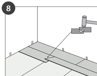
Nach der endgültigen Installation der Plankensperre ist es sinnvoll nochmal abschließend mit einem weichen Gummihammer und Schlagklotz die Klickverbindung anzuklopfen, damit die Planken höhengleich und fugenlos fest verbunden sind.
