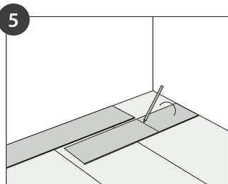
Markieren Sie die letzte Planke der Reihe nach dem Messen auf der Rückseite und sägen diese passgenau. Das Reststück der Planke kann den Anfang der nächsten Reihe bilden, sofern es ausreichend lang ist.
