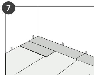
Nach dem runterdrücken der Planke ist es sinnvoll nochmal mit einem weichen Gummihammer sicherzustellen, dass die Verriegelung eingerastet ist und beide Planken höhengleich liegen.
