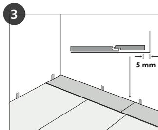
Entfernen Sie bei der ersten Plankenreihe die wandseitige Feder und lassen beim Verlegen einen Wandabstand von mind. 5,0mm.
