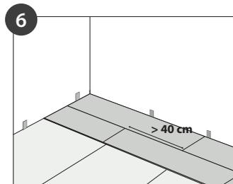
Bitte beachten Sie das der Fugenversatz mind. 40cm beträgt. Die nächste Planke wird wieder zunächst längsseitig in einem Winkel von ca. 25°-30° angesetzt und noch vor dem endgültigen Einklicken an die kurze Stirnseite gedrückt bevor es endgültig runtergedrückt wird (Fold-Down System).
