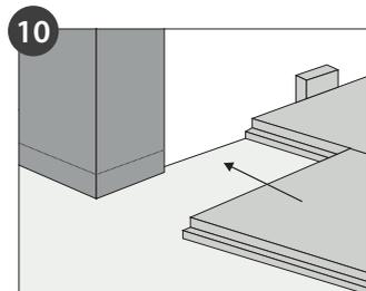
Beim anpassen von Planken an Türzargen ist ebenfalls der Randabstand von mind. 5,0mm einzuhalten. Holz-zargen können auch alternativ unten gekürzt werden. Bei Metallzargen sollten die Fugen mit entsprechender Dichtungsmasse farblich passend versiegelt werden.
