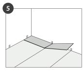
Die Planken der ersten Reihe werden zuerst auf der kurzen Stirnseite verbunden. Es wird in einem Winkel von 25° angesetzt und eingeschwenkt. Achten Sie darauf, dass diese auf der Stirnseite exakt gerade ausgerichtet sind.
