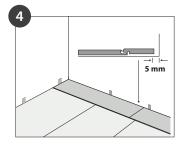
Beginnen Sie die Verlegung in der linken Raumecke. Die Verlegung erfolgt von links nach rechts. Lassen sie überall einen Rand-bzw. Wandabstand von mindestens 5 mm oder mehr.
