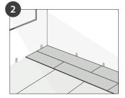
Die empfohlene Verlegerichtung ist längsseitig zur einfallenden Hauptlichtquelle. Als maximale zusammenhängende Verlegefläche empfehlen wir 10,00mtr. x 10,00mtr. Größere Flächen darüber hinaus bedürfen der Absprache und Freigabe durch unsere Anwendungstechnik. Zu allen aufstrebenden Bauteilen, wie Wände, Säulen oder Türdurchgängen sowie angrenzenden Flächen müssen entsprechende Dehnungsfugen fachgerecht eingebaut werden.
