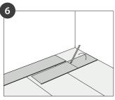
Markieren Sie die letzte Planke der Reihe nach dem Messen und kürzen diese passgenau. Das Reststück der Planke kann den Anfang der nächsten Reihe bilden, sofern es ausreichend lang ist.
