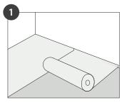
Bei aufsteigender Feuchtigkeit aus dem Estrich verwenden Sie die Aqua-Stop Folie wie beschrieben. Die Folie sollte an den Wänden mind. 2cm hochgezogen werden und an den Stoßfugen mind. 10 cm überlappen.
