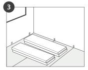
Wir empfehlen bei der Verlegung die Planken wechselweise aus mind. 3 verschiedenen Paketen zu entnehmen und zu mischen, um das gewünschte Dekorbild zu erlangen.
